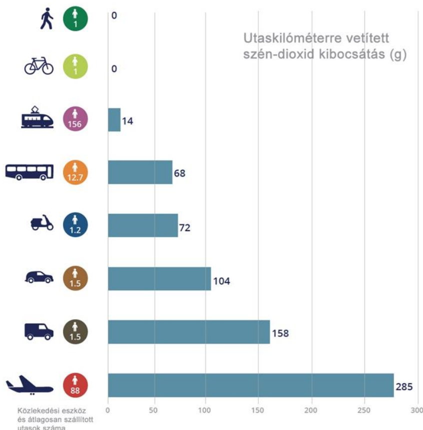
14. ábra: A különböző közlekedési eszközök utaskilóméterre vetített szén-dioxid kibocsátása Forrás: www.eea.europa.eu 7
